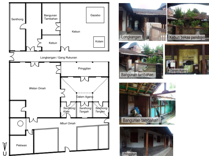
Gambar 5. Denah dan Kondisi Eksisting Bangunan R09
