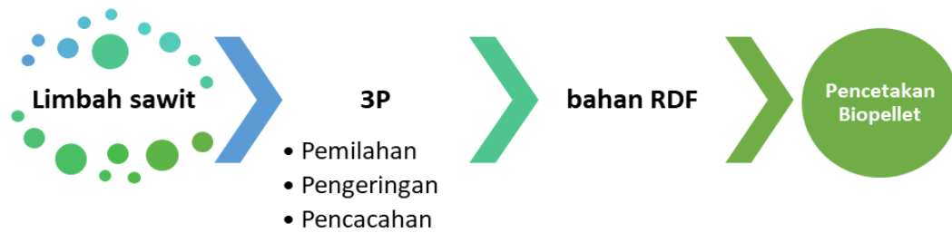
Gambar 2. Alur pengolahan limbah kelapa sawit menjadi biopellet
