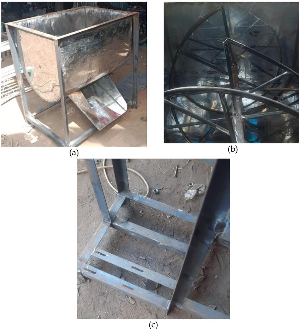
Gambar 2. (a) Rangka dan *hopper* pengaduk, (b) Dudukan motor penggerak, (c) *Screw* pengaduk
