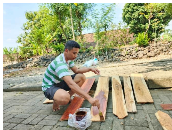
Gambar. 6 Pengecatan kayu dengan Plitur
